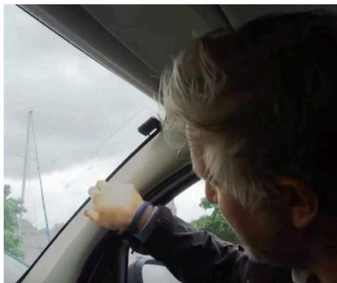
3. Idealerweise wird die Antenne auf der Beifahrerseite montiert. Es sollten mindestens 4 cm Abstand zwischen dem Rand der Frontscheibe und dem senkrechten Streifen der Folienantenne eingehalten werden, wie im Bild gezeigt.
